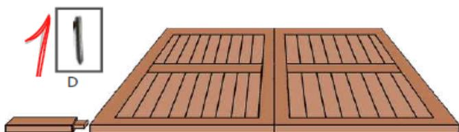
Positionner les 2 vantaux à plat sur des cales. Joindre les vantaux.
