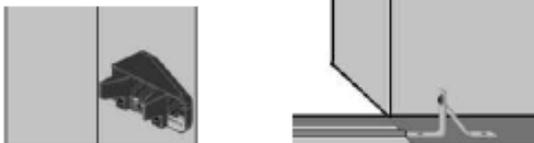
Positionner la gâche (cf. notice) et le heurtoir. Tracer l'emplacement puis fixer avec les vis et les chevilles.
