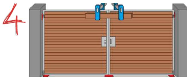
Solidariser les vantaux avec une cale et des serre-joints (laisser un jeu de 15mm entre les 2 vantaux).
