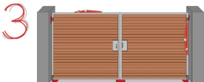
Mettre d'aplomb les vantaux, puis les régler (régler les jeux entre chaque vantail et pilier à l'aide de cales de 25mm).
