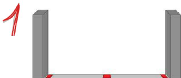
Mettre en place des cales dessous, laisser un jeu de min 25mm. Au sol, tracer la ligne des battants (faire attention que le portail ne touche pas le sol en position ouverte).
