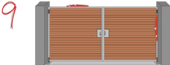
Repositionner les vantaux, recontrôler l'aplomb des vantaux et tester leur ouverture.
